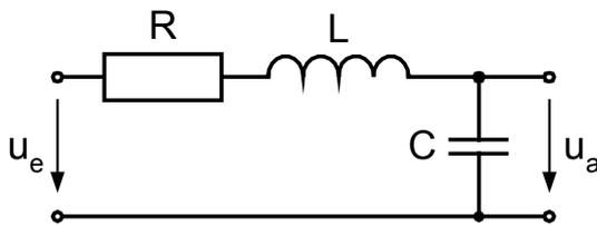
Bild 1 Einfaches RLC-Netzwerk mit Eingangsgröße  $u_e$  und Ausgangsgröße  $u_a$
